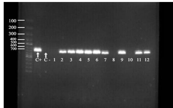
شکل ۱. تصویر ژل آگارز حاوی نمونه‌های PCR حاصل از تکثیر ژن oqxA . چاهک اول مارکر 100bp، چاهک دوم حاوی کنترل مثبت و چاهک سوم حاوی کنترل منفی. سایز باند ژن oqxA 699bp است.
