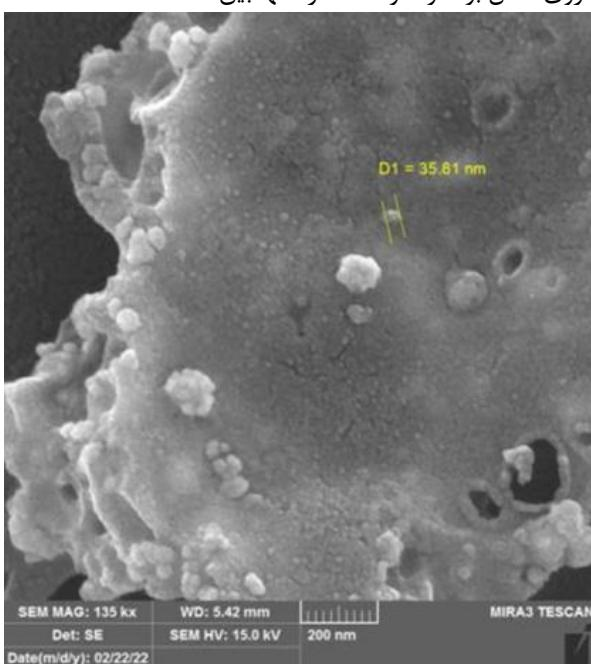
شکل ۲. تصویر میکروسکوپ الکترونی روبشی (SEM) با نانو ذرات نقره سنتز شده و دو فاکتور مؤثر بهینه
