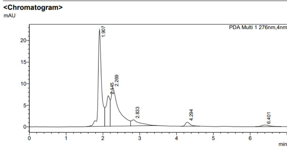
شکل ۲. کروماتوگرام حاصل از تزریق نمونه‌ی پلاسمای حاوی ۰/۲۵ میکروگرم در میلی لیتر آپیکسابان. وجود پیکی در زمان حدود ۴/۴ دقیقه که در نمونه حاوی دارو مشاهده می‌شود نشان دهنده انتخابی بودن روش توسعه یافته می‌باشد.
