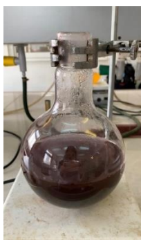
شکل ۳. تغییر رنگ محلول طلا بعد از جوشیدن و انجام تیتراسیون و احیا شدن نمک طلا
