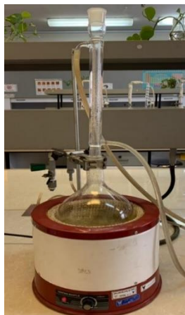
شکل ۲. سیستم رفلاکس شوف بالن.
